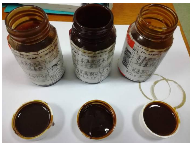
图 2.1 立磨磨辊在用油外观（从左到右分别为 1#、2#、3#磨辊）
